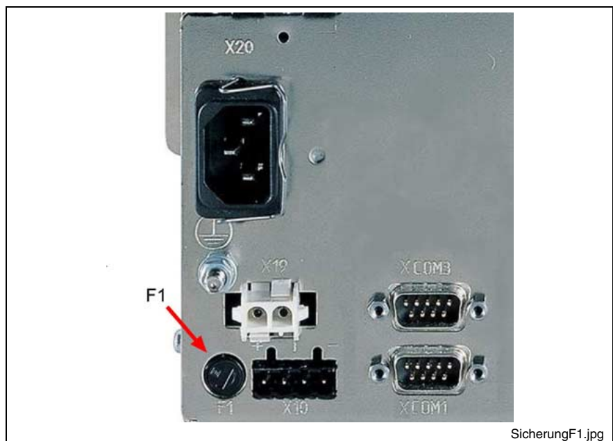
Fig. 8-7: Fuse F1 on the connector panel
